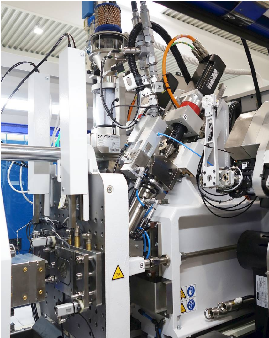
Abb. 2: 2-stufige Schnecken-Kolben-Aggregate der MicroPower COMBIMOULD LIM
