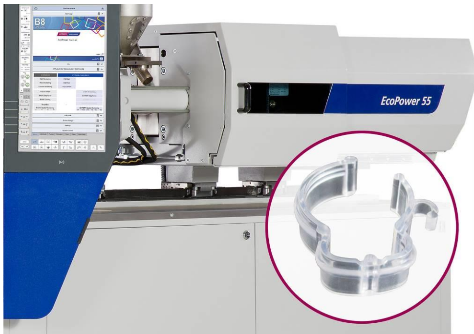
Fig. 3: collier de serrage pour la technologie médicale, produit sur une cellule de production EcoPower 55/350 WITTMANN 4.0 (photo du collier de serrage : WILAméd GmbH)
