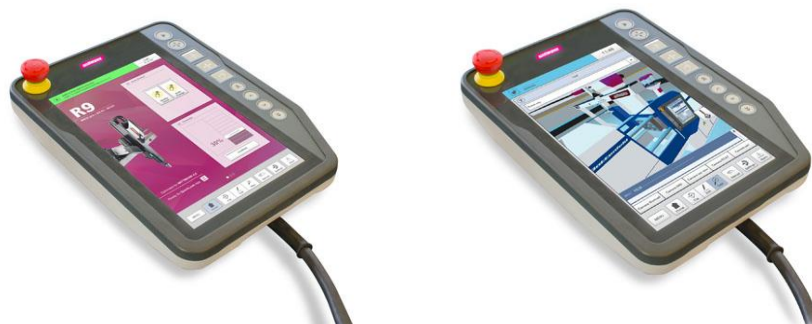
A gauche : console de pilotage robot R9 de WITTMANN avec page d'accueil, à droite : affichage d'une cellule de travail connectée.
