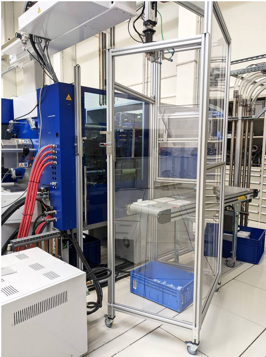
Fig. 2: Easy Cell décalée pour permettre l'accès au moule
