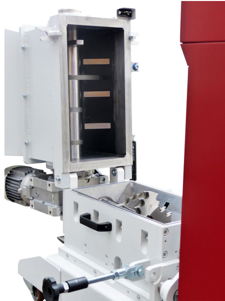
Der aufgeklappte Materialtrichter der S-Max 3 erlaubt den Blick auf den zusätzlichen Einzug von unten.
