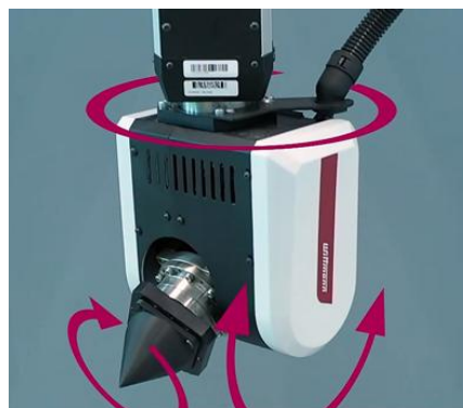
Schematische Darstellung zusätzlicher Servo-Rotationsachsen.
