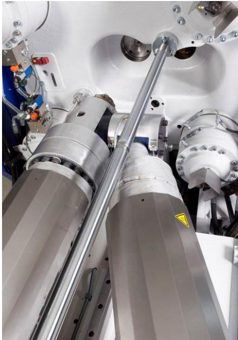
Abb. 3: Y-Anordnung der Spritzaggregate
