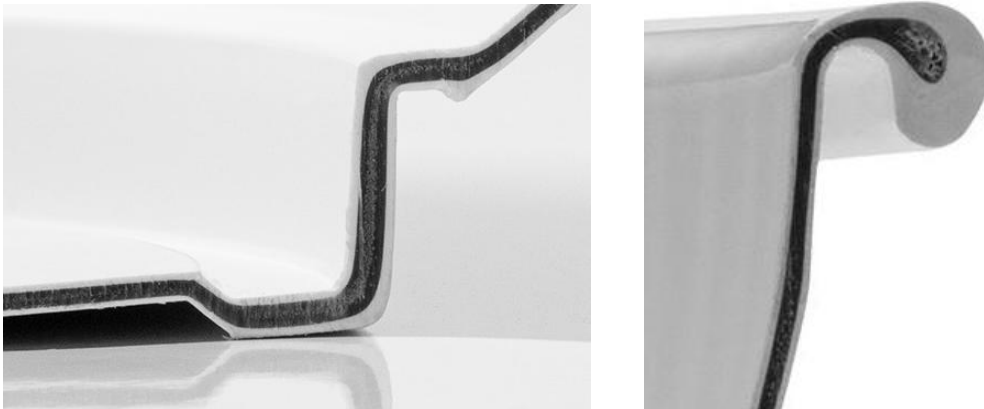
Abb. 1a+b: 3-Kernmaterial geschäumt zur Vermeidung von Einfallstellen
