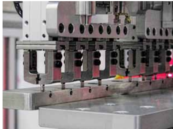
Links: Mikro-Einlegeteile, auf den Pins eines Shuttle abgelegt, vor der Übernahme durch einen Roboter. Die rote Blitzlichtbeleuchtung ist Teil des von der Kamera durchgeführten Inspektionsvorgangs. Rechts: Das End-of-Arm-Tooling nimmt die Mikroteile auf.
