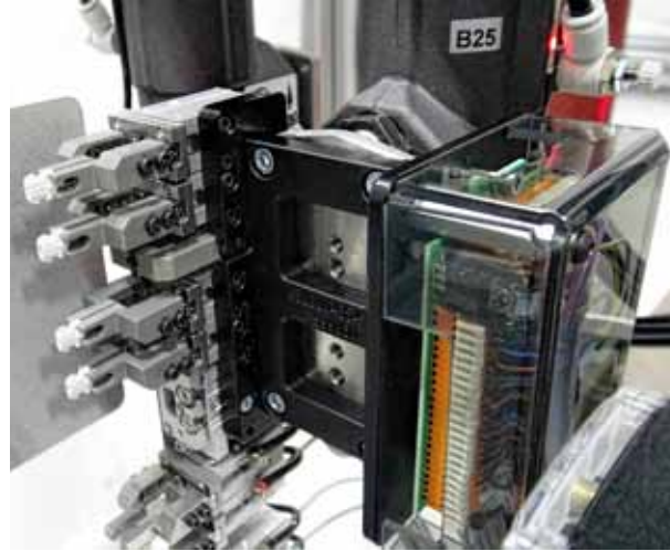
Links: WITTMANN W822 Roboter mit geeignetem End-of-Arm-Tooling. Ab gewissem Produktionsausstoß nutzen viele Spritzgießer horizontale Spritzgießmaschinen und von oben einfahrende Roboter. Rechts: End-of-Arm-Tooling, das die Teile einer Cognex Kamera präsentiert (rechts im Bild).
