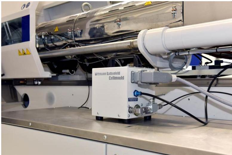
**Abb. 3a:** CELLMOULD®-Modul auf *MacroPower 1100*
