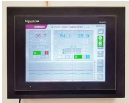
Von außen hermetisch abgeriegelt, können die aktuell in der Kammer herrschenden klimatischen Verhältnisse an einem Touch-Terminal abgerufen werden.
