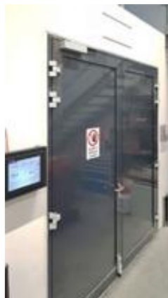
Von außen hermetisch abgeriegelt, können die aktuell in der Kammer herrschenden klimatischen Verhältnisse an einem Touch-Terminal abgerufen werden.
