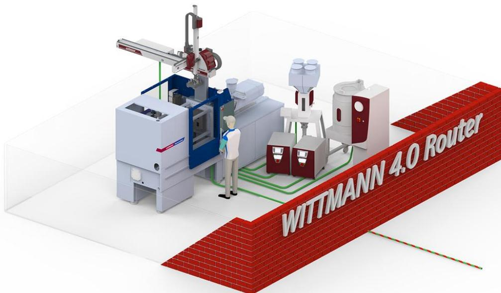
**Schematische Darstellung der Arbeitszellen-Abschirmung.**
