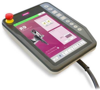
Abb. 3: WITTmann R9 Teachbox – der Display-Rahmen wird auf einer SmartPower 240 gespritzt
