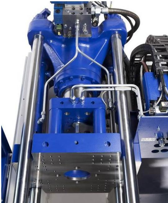
**Abb. 2:** Zentralhydraulisches Schließsystem der *SmartPower*
