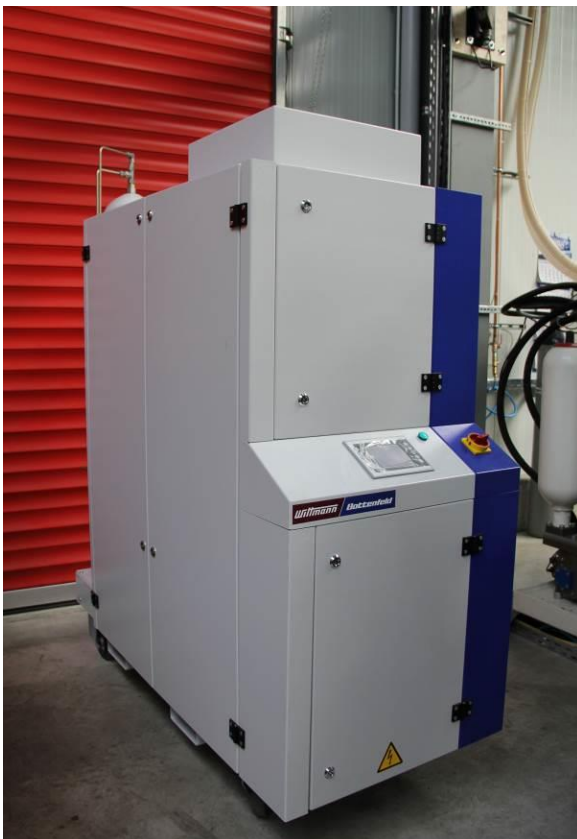
Abb. 2: Druckherzeugungsanlage von WITTMANN BATTENFELD für das Gasinjektionsverfahren AIRMOULD® und das Strukturschaumverfahren CELLMOULD®
