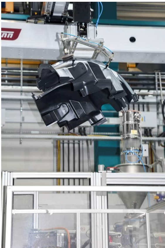
Abb. 4: Entnahme und Ablage einer Radlaufschale mit einem WITTMANN Roboter WX173 (Foto: WITTMANN BATTENFELD)
