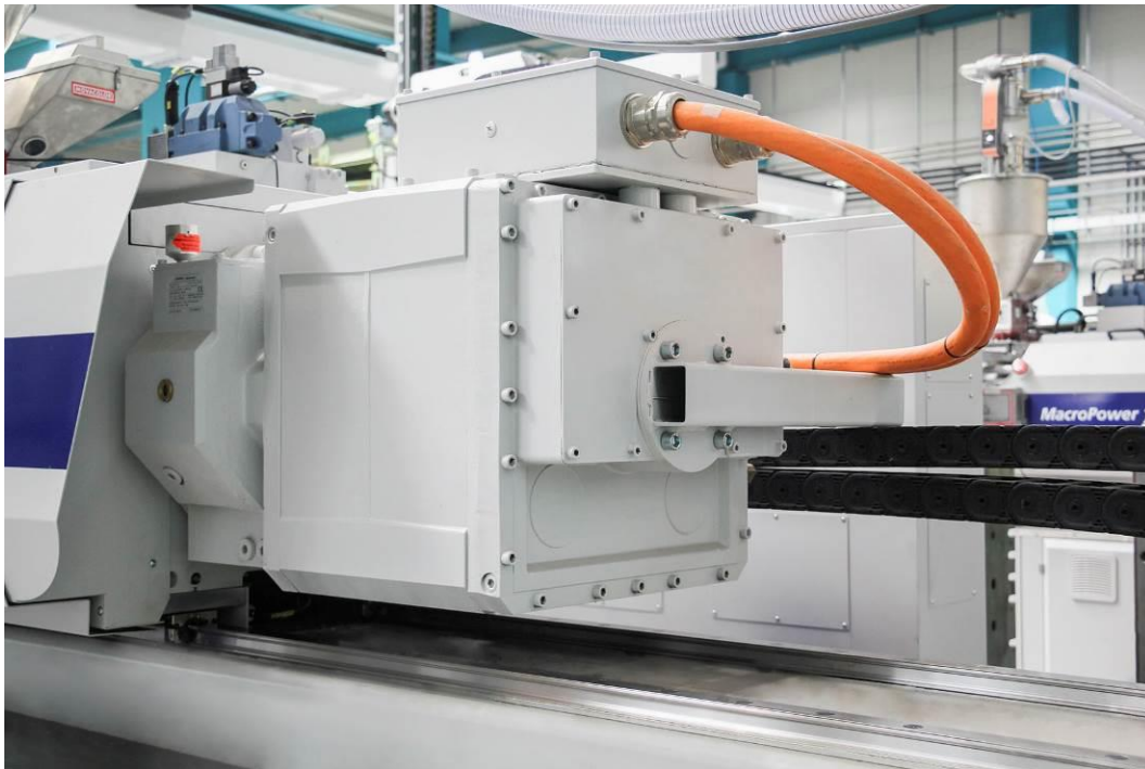
Abb. 3: Servoelektrischer Schneckenantrieb auf MacroPower 2000 (Foto: WITTMANN BATTENFELD)
