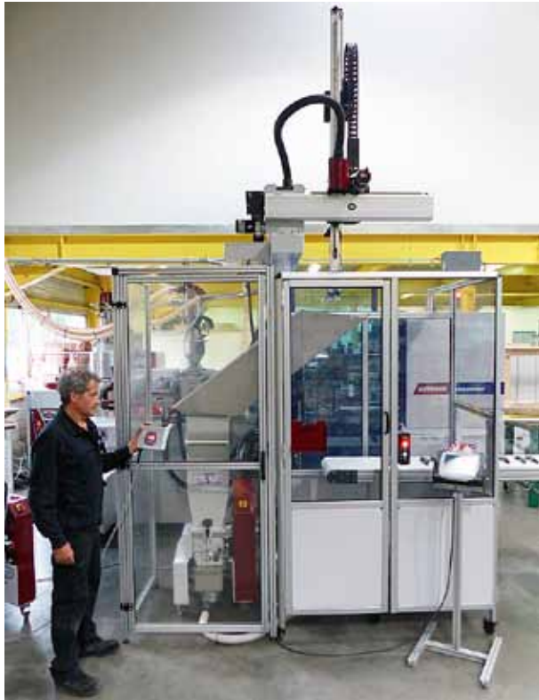
G-Max Mühle in der Schutzeinhausung einer Arbeitszelle.
