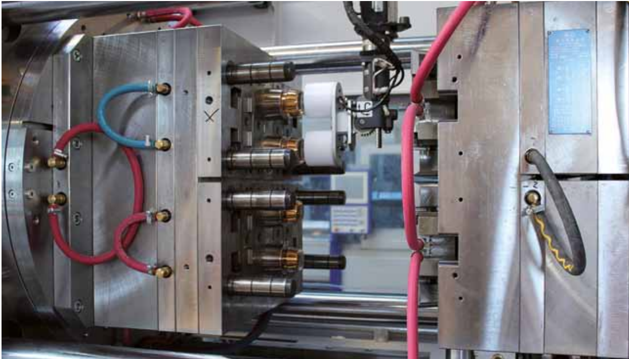
Werkzeug zur Herstellung von Cremedosen in 2-Farben-Technologie.
