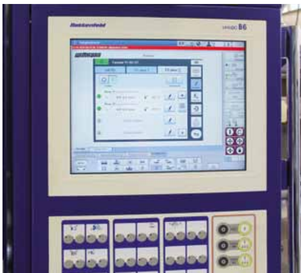
FLOWCON plus, integriert in die B6 ® Maschinensteuerung.
