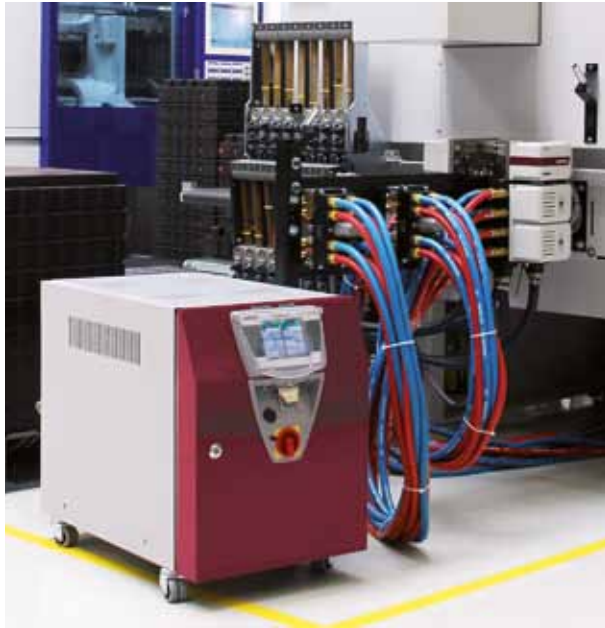
FLOWCON plus und TEMPRO plus D Temperiergerät.
