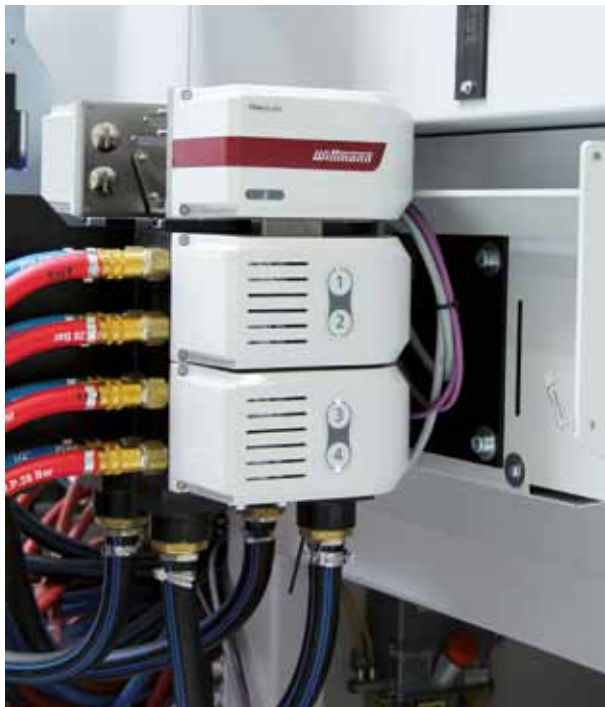
Bei COLOP im Einsatz: Der neue FLOWCON plus von WITTMANN verbessert die Temperaturverteilung im Werkzeug.
