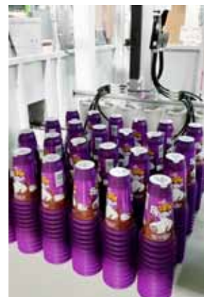
Im Bild links die Inspektion des produzierten Teils: Ansicht der Anzeige des bei AMRAZ in Betrieb befindlichen optischen Prüfsystems. Rechts fertig produzierten Becher, die von einem WITTMANN W818 Roboter auf einem Förderband abgestapelt wurden.
