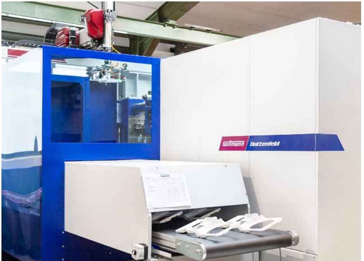
Fertigung Gehäuseteil für Getränkeautomat mit SmartPower 300/1330 mit Insiderzelle.
