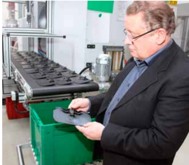
Dieter Diekmann prüft Schwappwände. Linkes Bild: Diese Schwappwand mit strömungsrelevanten Noppen ist für den Einbauvorgang in den Kraftstofftank biegsam ausgeführt. Rechtes Bild: Nahezu in „Geisterschicht“ entstehen diese Zulieferteile aus modifiziertem HDPE zu Hunderttausenden.
