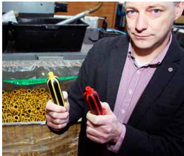
Bild links: Liesa Feikes, Werkzeugmacherin im dritten Ausbildungsjahr, wählt eine Graphitelektrode aus. Diese Komponenten für das Erodieren stellt der Verarbeiter in Leer selbst her. Bild rechts: Zwei-Komponententechnik in unterschiedlichen Farben für Elektroartikel. Holger Meyer, stellvertretender Betriebsleiter, präsentiert zwei Handlampen-Griffe aus LDPE und farbigem TPE.
