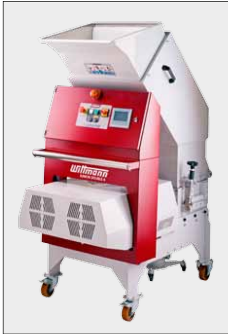
WITTMANN JUNIOR DOUBLE Zahnwalzenmühle. Bild rechts: Ansicht der Mahlkammer der WITTMANN JUNIOR DOUBLE Mühle mit zwei Rotoren zur Vermahlung großer Angüsse und Teile. Die optionale Einzugschwalze ist im aufgeklappten Einzugstrichter montiert.
