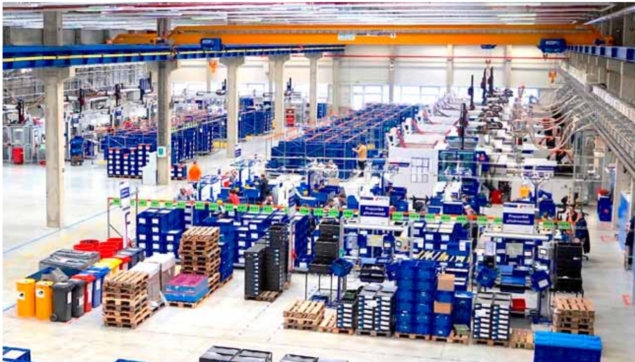
14 WITTMANN BATTENFELD Spritzgießmaschinen im Schließkraftbereich von 1.800 bis 5.500 kN produzieren bei WITTE Ostrov rund 3,5 Mio. Türgriff-Baugruppen für Automobile.
