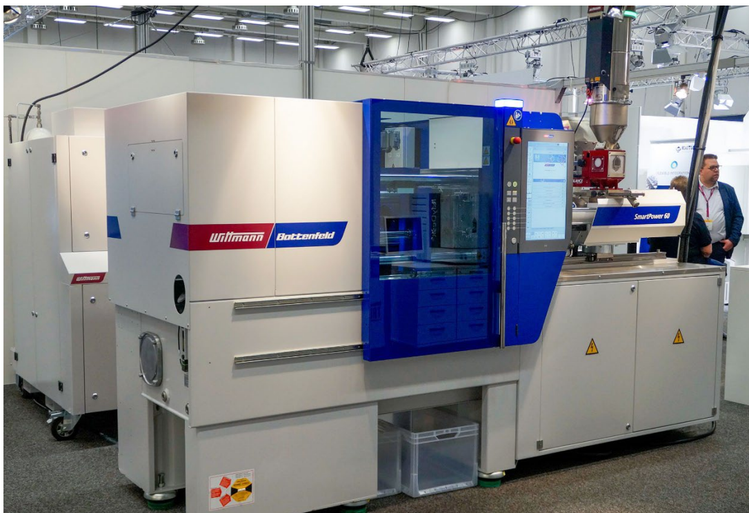
Abb.: SmartPower 60/120 mit Gasinnendruck-Technologie Airmould 4.0
