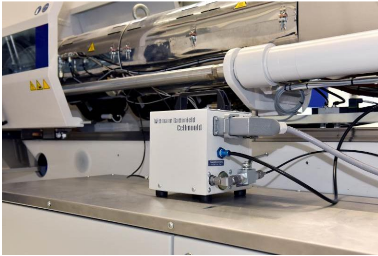
Fig. 3a: CELLMOULD® module on a MacroPower 1100
